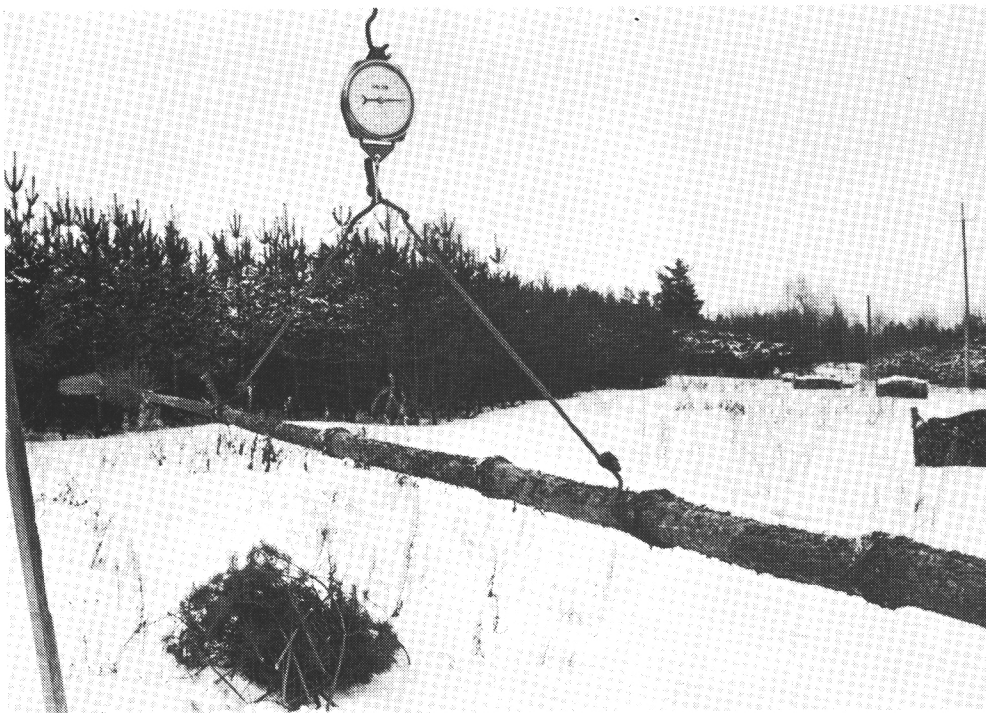
Kuva 2. Satoindeksin määrittystä varten koepuut joudutaan kaatamaan. Fig. 2. Assessing harvest index is a destructive procedure.
