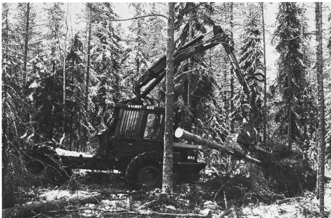
Kuva 4. Tapio-kuormainharvesteri Valmet 872 -kuormatraktorissa Fig. 4. Tapio tree harvesting head mounted on Valmet 872 forwarder
