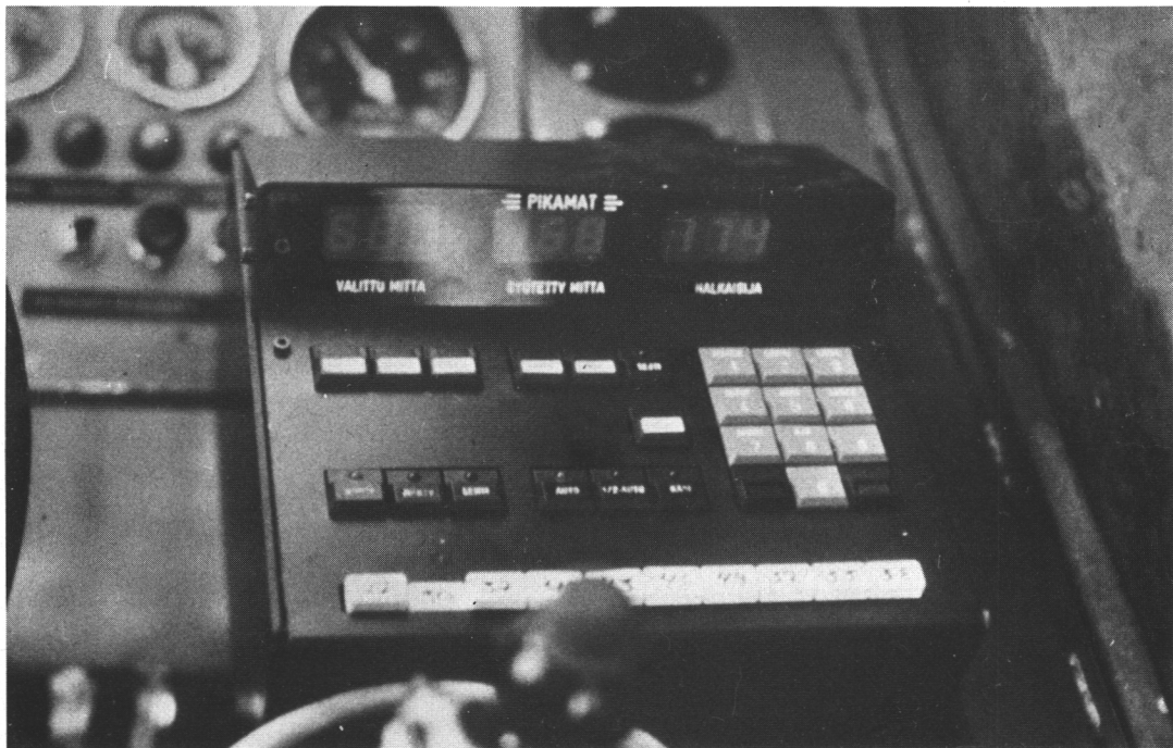
Kuva 2. Mikroprosessori PIKA 75:n ohjaamossa. Fig. 2. Microprocessor in the cabin of PIKA 75.
