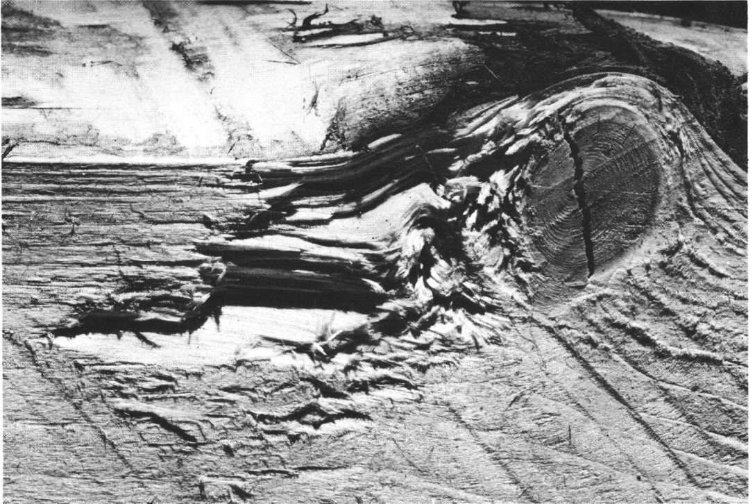
Kuva 5. Sahatavarakappaleen pinnan repeämä oksan vieressä. Fig. 5. Tear on the surface of a sawn timber piece adjoining a knot.
