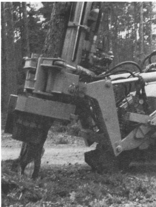
Kuva 12. Treemax kokopuuharvesterin prototyyppi irrottamassa puuta maasta. Peruskoneena Allis Chalmers kuormaaja (kuva Mikko Kantola). Figure 12. Treemax complete tree harvester prototype in extraction work. Basic machine Allis Chalmers loader (photo Mikko Kantola).
