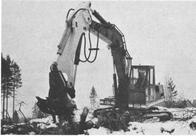
Kuva 2. RH 6 kaivukone varustettuna KH-120 nosto-paloittelulaitteella. Figure 2. RH 6 excavator equipped with a KH-120 extraction-splitting device.
