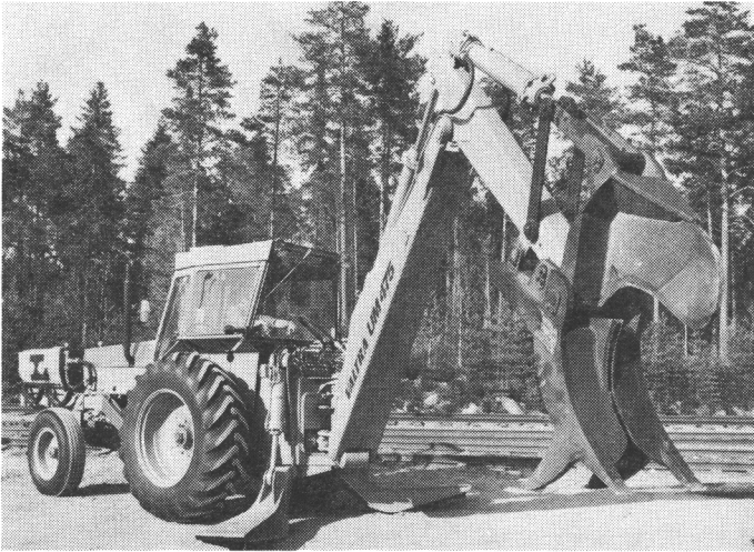
Kuva 5. Valtra UM 475 kaivuri varustettuna KH-10 nosto-paloittelulaitteella. Figure 5. Valtra UM 475 equipped with a KH-10 extraction-splitting device.
