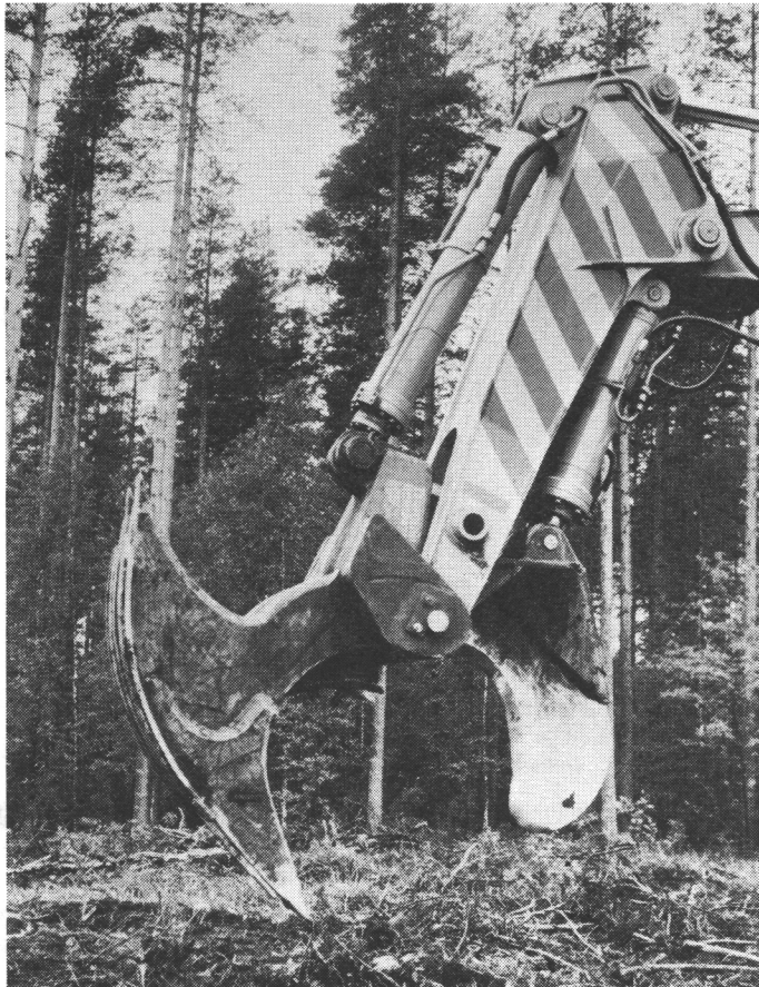
Kuva 7. KH-116 nosto-paloittelulaite (kuva Joutseno-Pulp). Figure 7. KH-116 extraction-splitting device (photo Joutseno-Pulp).
