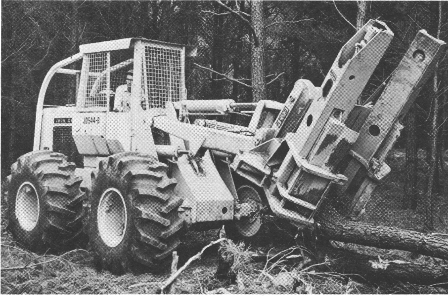
Kuva 15. Rome TX-1600 kokopuuharvesteri asettamassa puuta kasalle. Peruskoneena JD 544 B kuormaaja (kuva Peter Koch).
