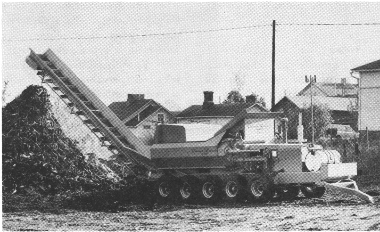
Kuva 10. Orasvuon kantoloukku (kuva Korpivaara Oy Konekemia). Figure 10. Orasvuo stump splitter (photo Korpivaara Oy Konekemia).
