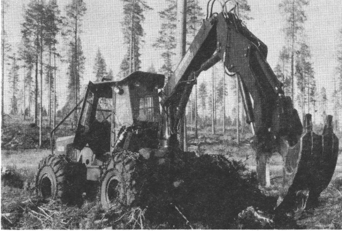
Kuva 4. Kockums 880 kaato-kasauskone varustettuna KH-120 nosto-paloittelulaitteella. Figure 4. Kockums 880 feller-buncher equipped with a KH-120 extraction-splitting device.
