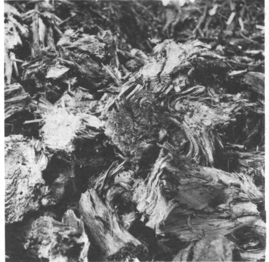
Kuva 33. Orasvuon Konepajan rakentamalla kantoloukulla pilkottua suokantoa.
