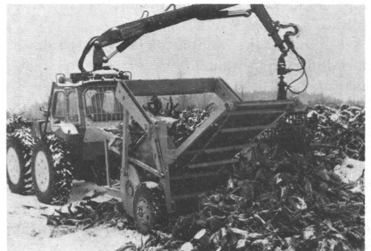
Kuva 13. Kantoloukku toiminnassa. Fig. 13. Stump crusher in operation.
