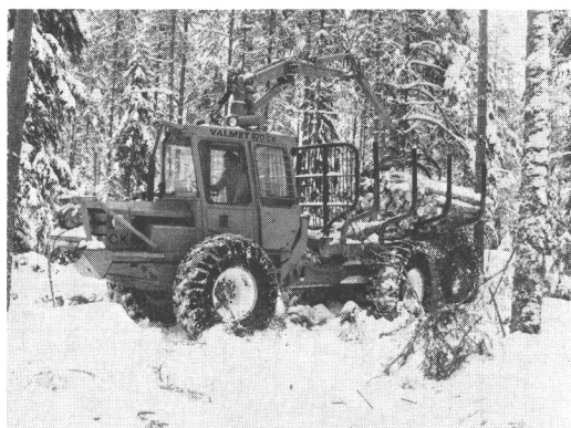
Kuva 4. Kone 2. Valmet 870 CK Fig. 4. Forwarder 2. Valmet 870 CK
