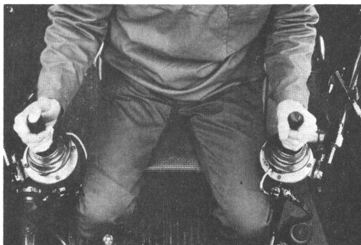
Kuva 6. 2-vipuohjaus Fig. 6. 2-control handling system of the loader
