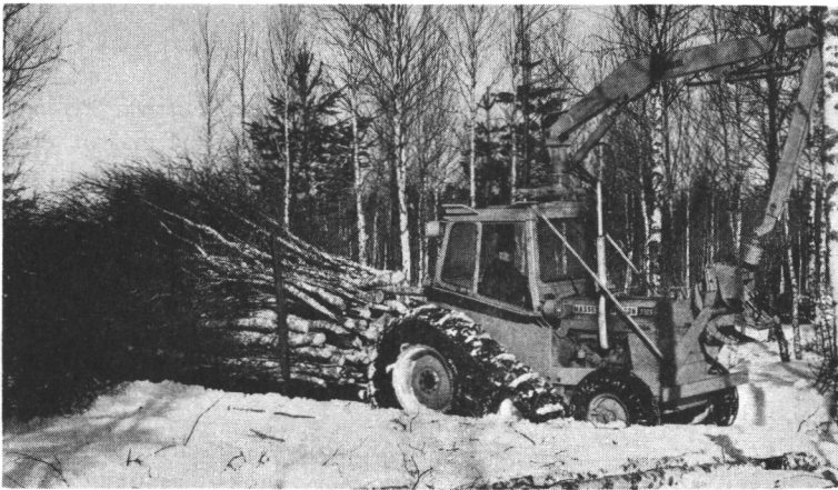
Kuva 30. Massey Ferguson 3305 traktori kokopuunkuljetuksessa Harvialassa. Figure 30. The Massey Ferguson 3305 tractor in full-tree transportation in Harviala.
