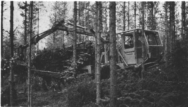
Kuva 31. Lokomo 925 kuormatraktori kokopuunkuljetuksessa Keuruulla. Figure 31. The Lokomo 925 forwarder in full-tree transportation in Keuruu.
