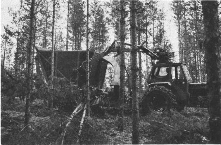
Kuva 24. PH-1 prototyypihakkuri palstalla ensiharvennusemetsikössä. Figure 24. The PH-1 prototype chipper in terrain in thinning conditions.
