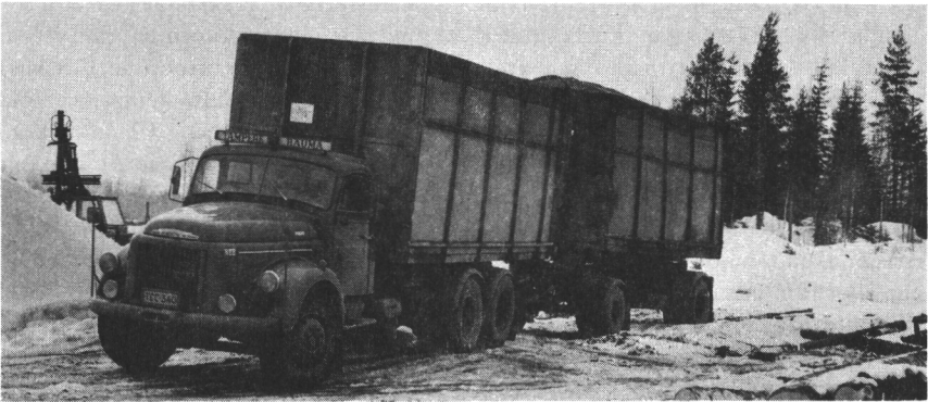
Kuva 36. Hakkeen kuljetukseen tarkoitettu täysperävaunulla varustettu kuorma-auto, jonka molemmat vaihtolavat voidaan laskea maahan. Autolava Oy:n Multilift vaihtolavajärjestelmä. Figure 36. A chip truck with trailer. Both chip containers can be detached to ground level. The Multilift system of Autolava Oy.
