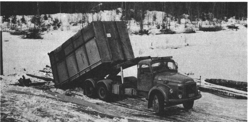
Kuva 37. Vaihtolavan nostaminen. Figure 37. Picking up a container.
