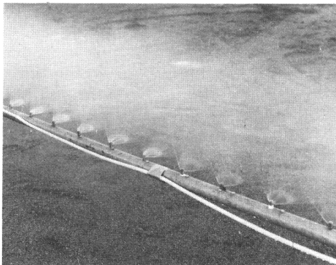
Kuva 14. Vasemmalla Floodjet- ja oikealla Tp-suuttimia toiminnassa. Figure 14. On the left Floodjet and on the right Tp nozzles in action.
