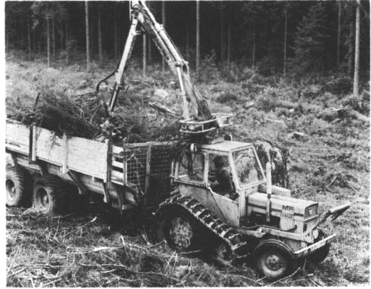
Kuva 6. Oksaraaka-ainetta kerätään kourakuormaajalla varustetulla MF-Robur traktorilla (kuvannut Teemu Ruoste). Figure 6. Branch raw material is collected by a MF-Robur tractor equipped with grapple loader (photo Teemu Ruoste).
