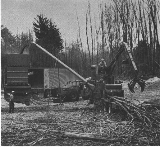
Kuva 7. Morbark Super Beaver kokopuuhakkuri. Figure 7. The Morbark Super Beaver whole-tree chipper.
