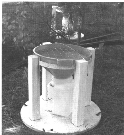
Kuva 2. Itiönkeruusuppilo, jolla voidaan kerätä sadevesinäytteitä surmakan itiöiden määrän analysointia varten. Kuva: Raija-Liisa Petäistö
