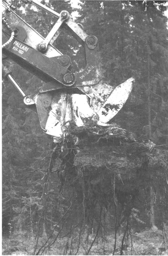
Kuva 2. Kantoharvesteri Pallari KH-160 on kehitetty kantojen nostamiseen ja lohkomiseen. Se myös tarvittaessa mätästää nostokohdan taimien istutusta varten. Kuva Erkki Oksanen.
