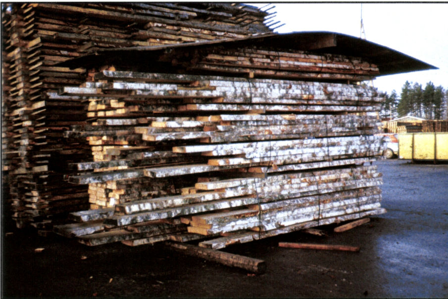
Kuva 16. Koivuliimalevyn valmistukseen käytettävää terveksaista sahatavaraa. Vilkon Oy, Hirvensalmi. Kuva: Erkki Verkasalo
