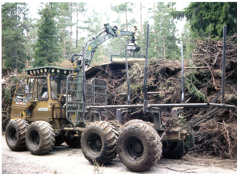
Kuva 22. Ruotsissa hakkuutähteen tienvarsivarasto peitetään talven varalle usein suojapaperilla, joka levitetään traktorin kuormaimesta riippuvan kehikon avulla. Traktorin kuormatilaa pidennetty (kuva Pentti Hakkila).
