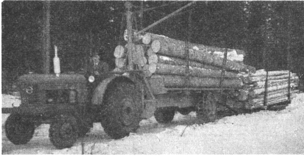
Kuva 4. Pyörätraktori varustettuna erikoisperävaunulla, jonka pyörät ovat vetävät. Perävaunun jäljessä reki. Kuorman (perävaunu + reki) nettopaino n. 14 tn ja ajoneuvon kokonaispaino n. 20.5 tn. — Huom. koneellinen kuormaustaite.
