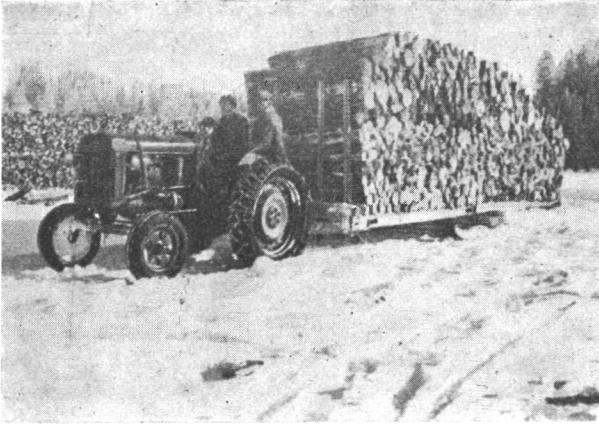
Kuva 1. Kahden tonnin pyörätraktori vetämässä n. 30 p-m 3 kuormaa. Tämän kaltainen kuljetus edellyttää tottunutta kuljettajaa, välivarastoon ajettua puutavaraa ja verraten määtöntä tietä. Valok. Metsäteho.
