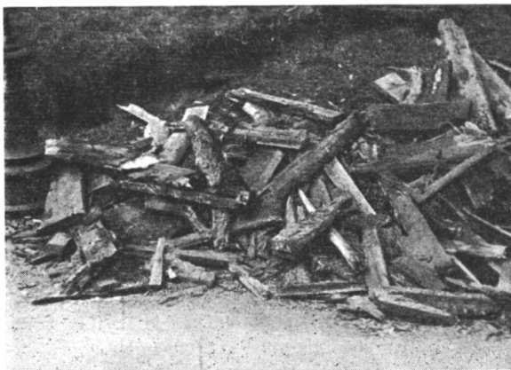
Kuva 1. Täydellisesti tuhoutunutta rakennuspuutavaraa maanalaisesta kellarista. Muutamassa vuodessa lahoaa kyllästämättömän puu tällaisissa paikoissa kun kyllästetty sitä vastoin kestää vuosikymmeniä.
