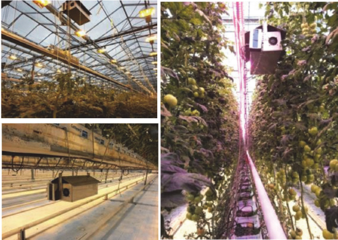
Bild 16. Mätlådnans placering. Vänster ovan: översta mätlådan och toppbelysning, vänster nedan: nedersta mätlådan och odlingsränna, höger: mellersta mätlådan och mellanbelysning. På dessa fotografier är plantorna inte fullt utväxta. Fullt utväxta når plantorna nästan upp till översta mätlådan. Foton Daniel Sjöholm.
