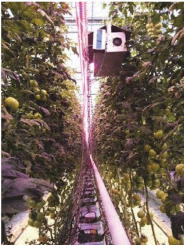
Bild 8. Visar den mittersta mätboxen vid HPS+LED området i blockväxthuset. I ändan av mätboxen kan man se temperatur och relativa fuktighet sensorn samt fläkten. Den mittersta mätboxen placerades något åt ena sidan och inte rakt under LED-armaturen. De övriga två mätboxarna placerades mitt mellan planraderna. (Foto Daniel Sjöholm, 10.3.2014)
