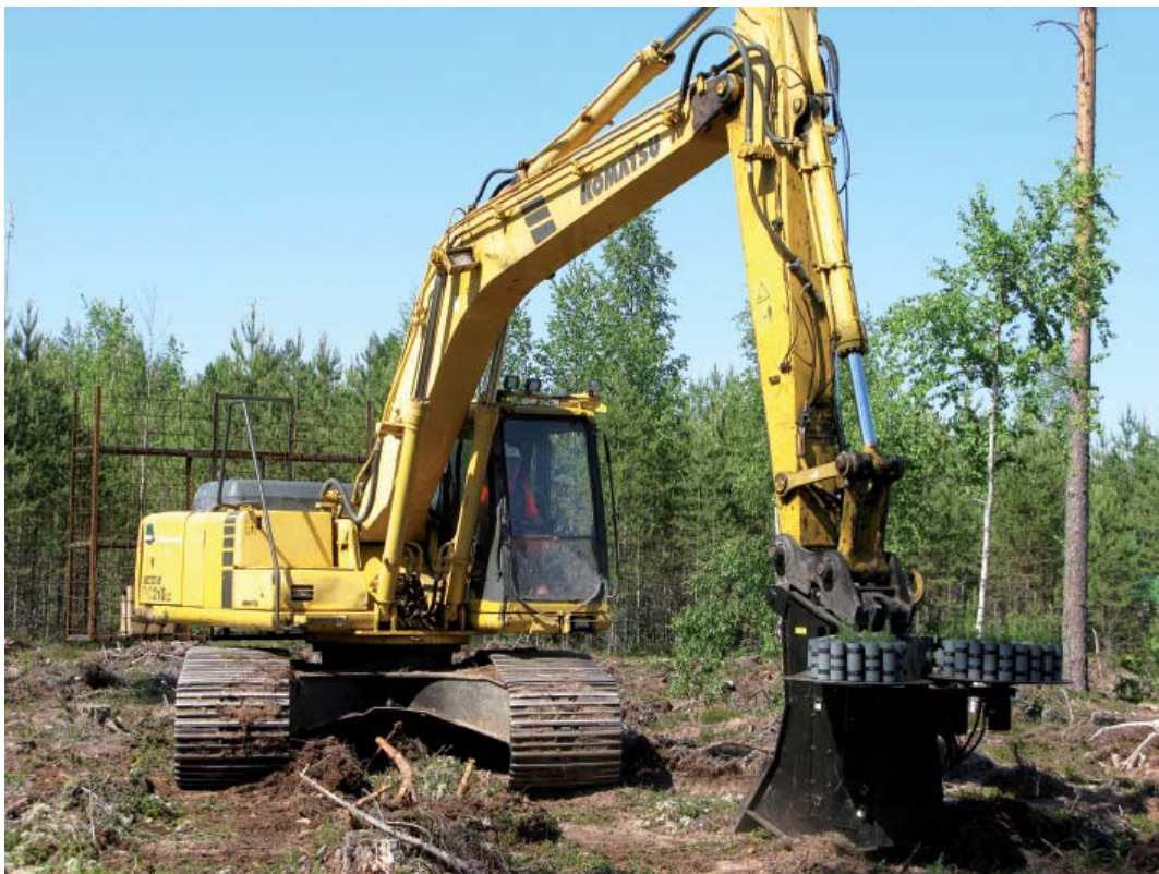
Kuva 7. Koneellisessa istutuksessa peruskoneena toimii keskiraskas kaivinkone. Kuva: Mikko Syri.
