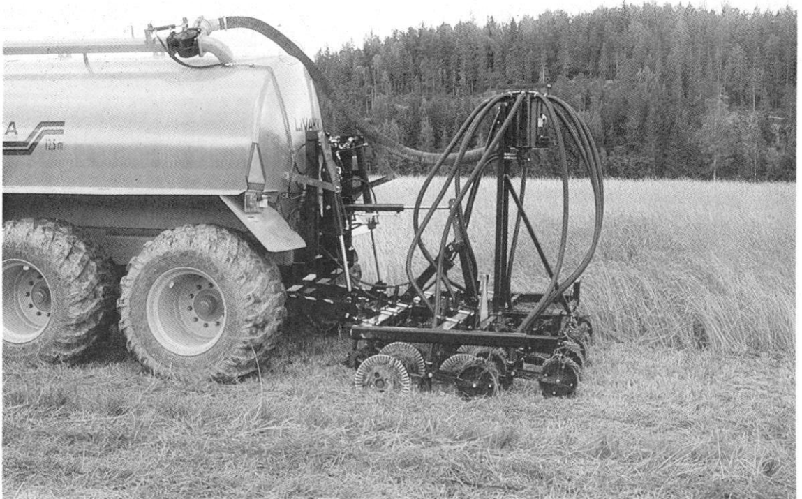
MTT/Vakolan ja Konepaja Kääriäisen yhteistyönä kehitetty lietelannan sijoituslaite suomalaisiin olosuhteisiin.
