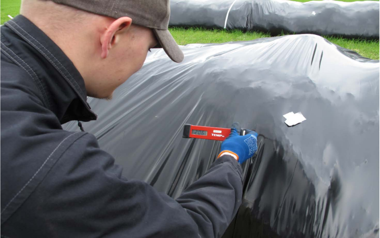
Kuva 9. Tuubikompostien lämpötilat mitattiin aumalämpötilamittari Temppi-150:llä 20 ja 100 senttimetrin syvyydestä.
