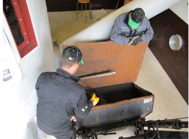
Reaktorimädätteen poistaminen alaventtiilistä
