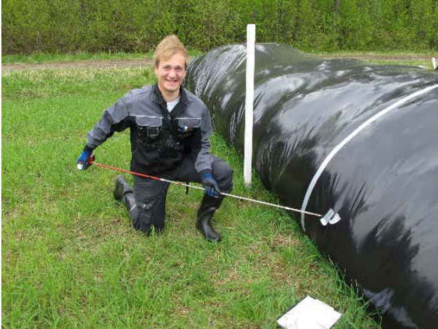
1. Pintalämpötilan mittaaminen 20cm syvyydeltä
