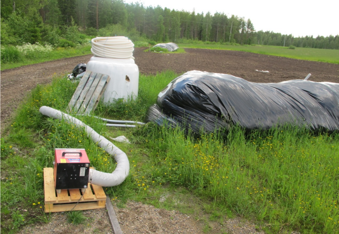
Kuva 12. Tuubikompostien koneellinen ilmastus Pullman Ermator A600 puhaltimella
