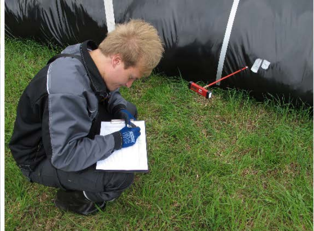
2. Sisälämpötilan mittaaminen 100cm syvyydeltä ja tulosten kirjaaminen taulukkoon
