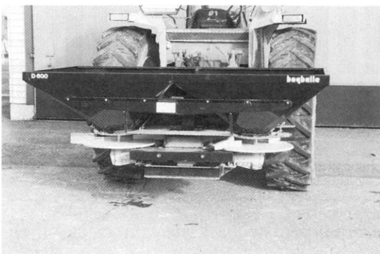
Kuva 7. Bögballe D600 -keskipakolevitin. Levitettäessä lannoitetta ojan pientareen lähellä on syytä vaihtaa oikean puolen lautaseen piennarsiivet ja säätää vasemman lautaseen siivet toiseen asentoon.
