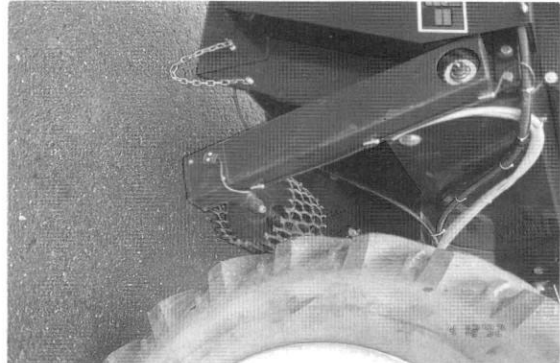
Kuva 11. Tume P1350 -puhallinlevitin. Tumen syöttölaitetta pyörittää traktorin takarengasta vasten painettava kitkarulla.
