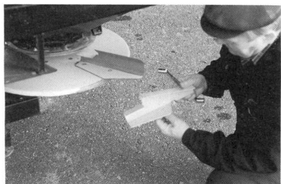
Kuva 7. Bögballe D600 -keskipakolevitin. Levitettäessä lannoitetta ojan pientareen lähellä on syytä vaihtaa oikean puolen lautaseen piennarsiivet ja säätää vasemman lautaseen siivet toiseen asentoon.
