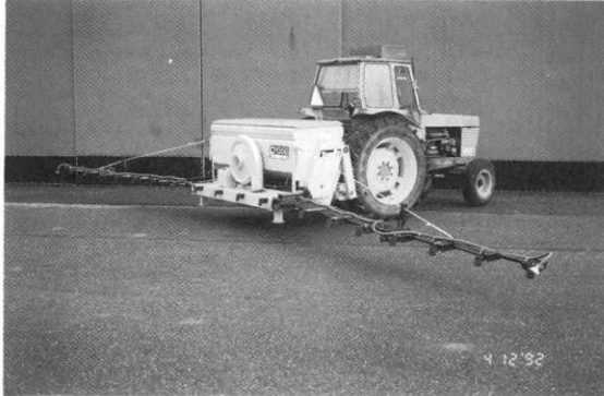
Kuva 11. Tume P1350 -puhallinlevitin. Tumen syöttölaitetta pyörittää traktorin takarengasta vasten painettava kitkarulla.
