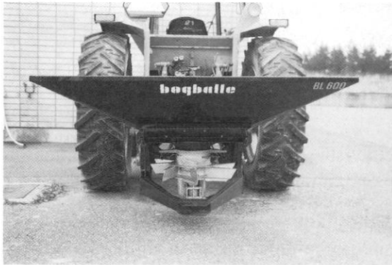
Kuva 6. Bögballe BL600 -keskipakolevitin. Säätöviput ovat erittäin hyvät, mutta niihin on vaikea ylettyä.
