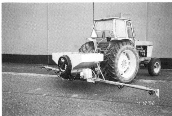
Kuva 12. Ylö Pneuma 707 -puhallinlevitin. Säätvivun suurehko välys ja lyhyt liikerata vaikeuttivat tarkkaa säätöä.
