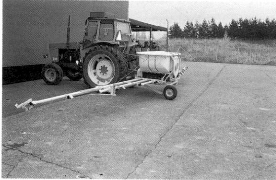
Kuva 9. Elho Matic 800 -puhallinlevitin. Syöttölaite saa käyttövoimansa joko voimanottoakselilta tai lisävarusteena saatavalta maapyörältä.
