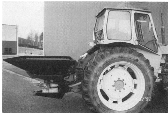
Kuva 6. Bögballe BL600 -keskipakolevitin. Säätöviput ovat erittäin hyvät, mutta niihin on vaikea ylettyä.
