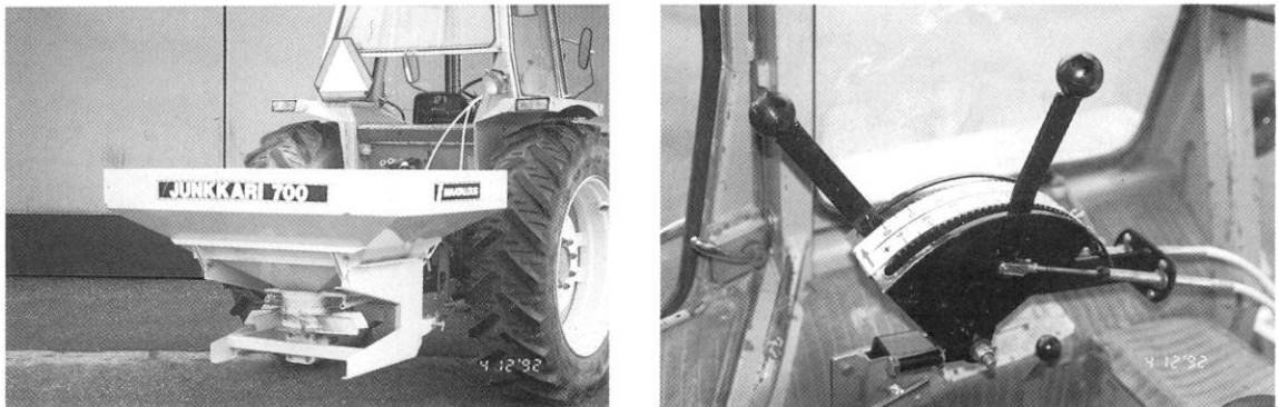
Kuva 10. Junkkari 700 -keskipakolevitin. Kaukosäätölaitteessa on vipu sekä lannoitemäärän että levityskuvion suunnan säätöä varten.
