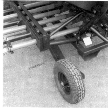
Kuva 9. Elho Matic 800 -puhallinlevitin. Syöttölaite saa käyttövoimansa joko voimanottoakselilta tai lisävarusteena saatavalta maapyörältä.
