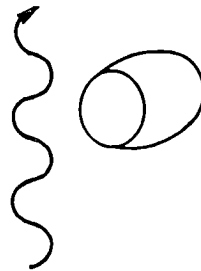
Kuvio 2. Ajotekniikka karhoa noukittaessa silloin kun karho on paalikammiota kapeampi (New Hollandin esite, ref. ANON 1986).
