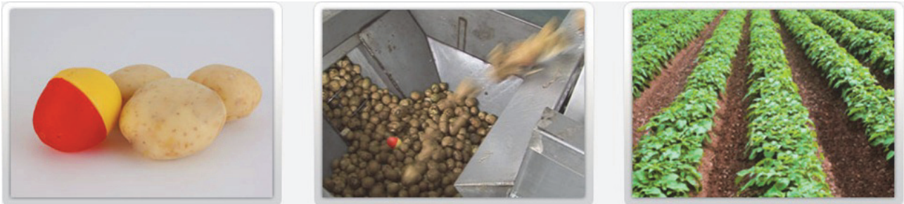
Kuva 4. Kiihtyvyyssanturin sisältämä elektroninen peruna (Smart Spud) voidaan laittaa mittaamaan mukuloihin kohdistuvia iskuja mihin tahansa perunaketjun vaiheeseen. Laite lähettää mitaamansa tiedot langattomasti ja reaaliaikaisesti käyttäjän tietokoneelle. (Kuvat: www.masitek.com).
