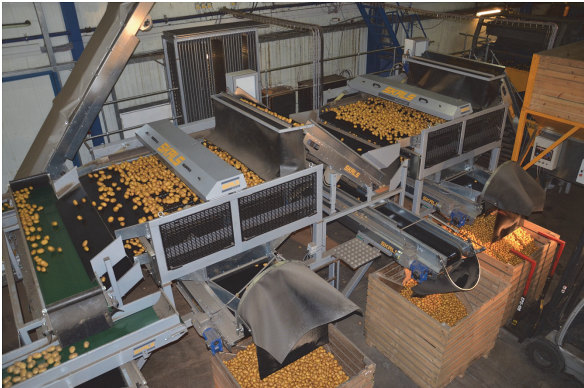
Kuva 8. Vaimenninläpät kuljetinhihnojen päissä vaimentamassa perunan putoamista laatikoihin (Kuva: Skals Maskinfabrik A/S).
