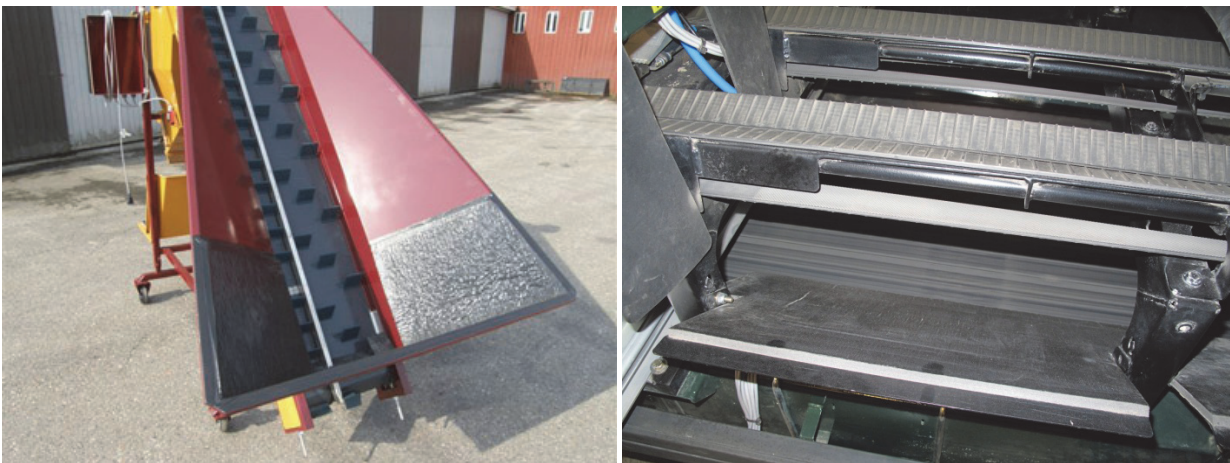
Kuva 7. Hyviä esimerkkejä oikein toteutetusta pehmustuksesta. Vasemmalla kotimaisen valmistajan kuljetin (Kuva: www.remet.fi ) ja oikealla hollantilaisen optisen lajittelijan pudotusluiska. (Kuva: Timo Lötjönen)
