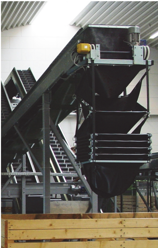
Kuva 9. Moniportainen pudotin vaimennin suurille pudotuskorkeuksille (Kuva: Skals Maskinfabrik A/S)
