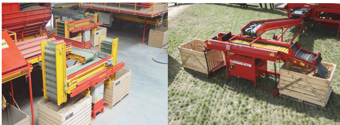
Kuva 5. Bijsma Hercules (vasemmalla) ja Grimmen (oikealla) valmistamat laatikointikoneet, joissa pudotuskorkeus säätöy elevaattorin päätä nostamalla. Toista laatikkoa voidaan täyttää sillä aikaa kun toista vaihdetaan. (Kuvat: www.bijlsmahercules.nl , www.grimme.com/de )
