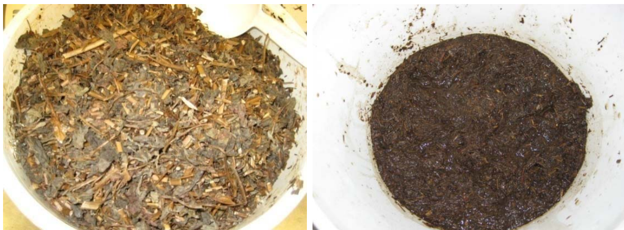
Kuva 7.1. Säilyttä puna-apilanurmea (vasemmalla, Jokioinen) sellaisenaan ja lietettynä reaktorisyytteenä, jota käytettiin II käsittelyjaksolla (oikealla, kevät 2010).
