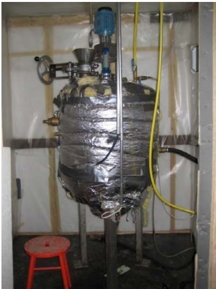
Kuva 7.2. Kooreaktori (200 litraa, HAMK, Hämeenlinna) ja syöttösuppilo.
