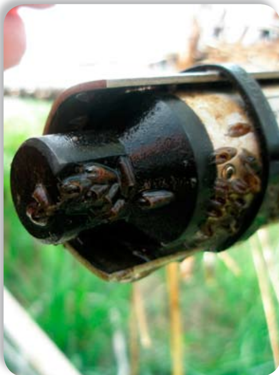
Kuva 4. Vanjärvellä toukokuun alkupäivinä 2008 sameusanturiin kiinnittyi mäkärän toukkia. Kuvassa toukat näkyvät kotelokoppineen. Toukkien takia anturin mittaustulos ei pysy ennalta määritettyjen raja-arvojen välissä, ja laadunvarmistusjärjestelmä antaa epäilyttävistä mittaustuloksista johtuvan hälytyksen. Kuva Lippo Sundberg.
