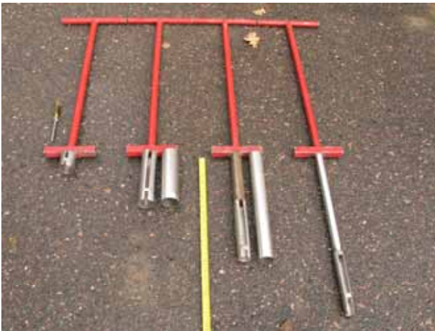
Kuva 7. Jäämänäytteiden otossa käytetyt maanäytekairat. Vasemmalta 0–6 cm, 0–20 cm, 20–40 cm ja 40–60 cm. Näytteiden sekoittumisen estävät 20 cm ja 40 cm pitkät terässylinterit vastaavien kairojen vierellä.
