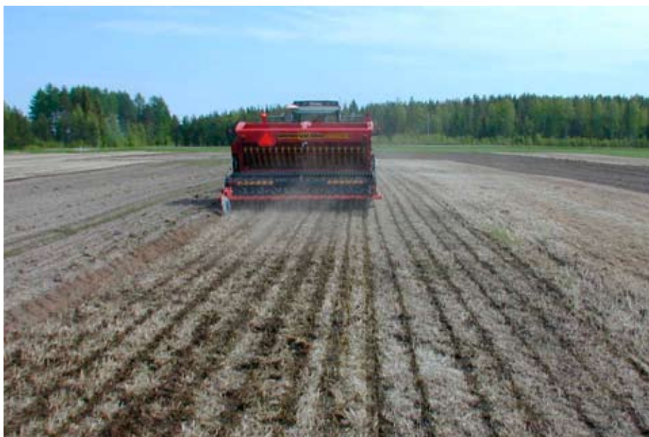
Kuva 2. Suorakylvökone multasi nurmen pintaan levitettyä lietalantaa vain vähän. Välittömästi koneen oikealla puolella on vielä kylvämätön kaista (kuvaaja: Mika Isolahti).
