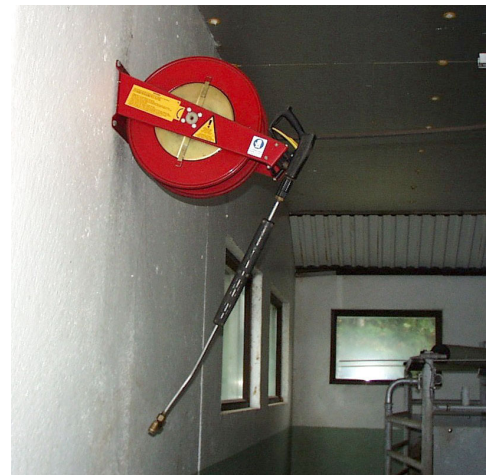
Kuva 6. Painepesuriin liitetty letkukela
