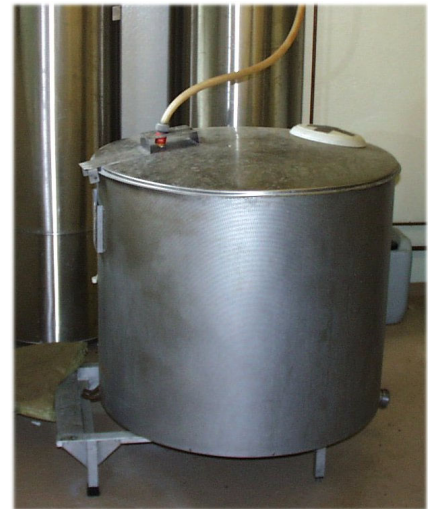
Kuva 4. Vanha tilasäiliö varastosäiliönä. Kestävä ja helposti puhdistettavissa oleva säiliö.
