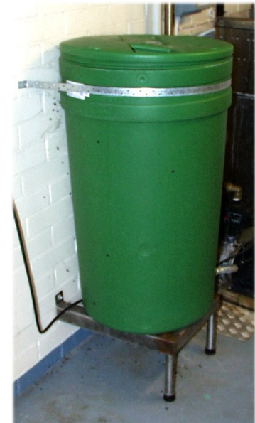
Kuva 5. Kannellinen muovisaavi varastosäiliönä, jonka pesu voi olla hankalaa syvyyden ja kapeuden vuoksi.
