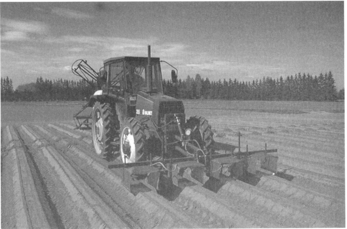
Riviruisku muutettuna porkkanan harjuviljelyyn sopivaksi. Säädettyssä suutinyksikössä on tuulisuoja ja kaksi suutinta. Suutinyksiköt on kiinnitetty tukipyörillä varustettuun runkopuomiin.
