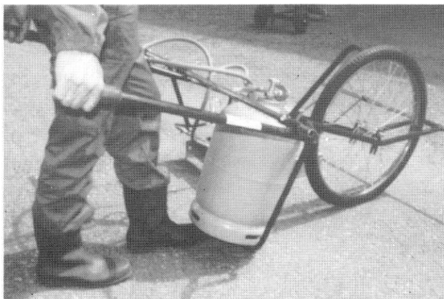
Kuva 9. Käveleminen on hankalaa pyörän ollessa rungon yläpuolella.
