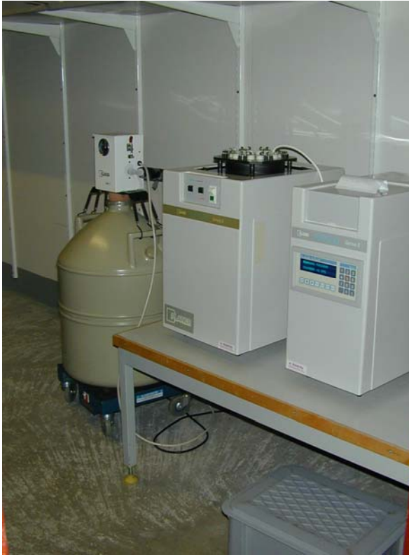
Kuva 6. Oksanpätkien hitaaseen jäädytykseen käytetty ohjelmoitava alkionpakastuslaite liitettynä laitteen kylmentämiseksi tarvittavaan nestetyypipulloon. Menetelmän nestetyypen kulutus on suuri.
