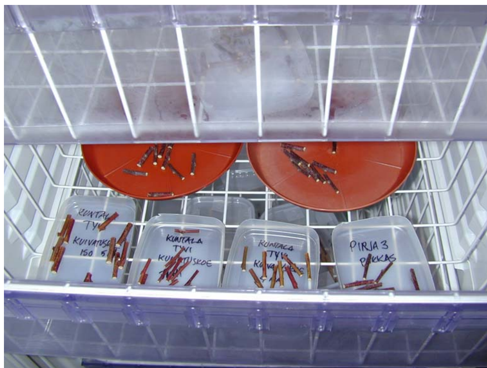
Kuva 5. Oksanpätkiä pakkaskuivatukseen käytetyssä ohjelmoitavassa jääkaappipakastimessa.
