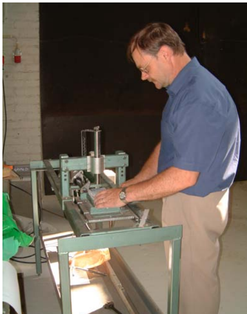
Kuva 7. Kitkan mittausta vetokitkamenetelmällä. Kuva: MTT Vakola
