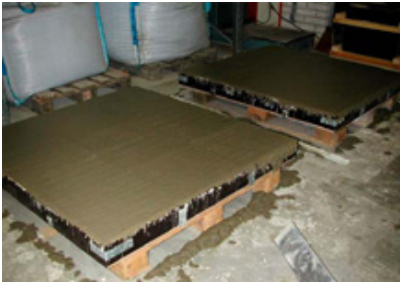
c) valetut alusbetonilaatat
