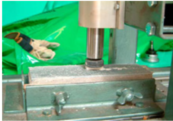
Kuva 8. Pinnan kuluttavuuden mittaamisessa käytetty menetelmä. Kuva MTT Vakola.
