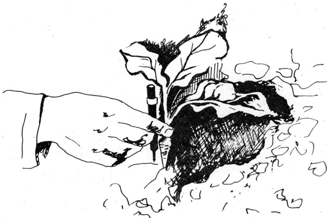
Kuva 16. Tasakärkinen M2-tyyppinen taskupenetrometri mittausvaiheessa sokerijuurikkaan juuritutkimuksessa.
