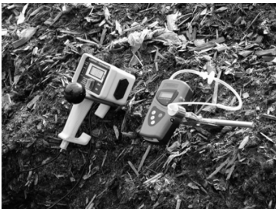
Kuva 2. Lämpötila- ja kaasumittaus kypsytysaumasta. Kuva: Tiina Tontti.
