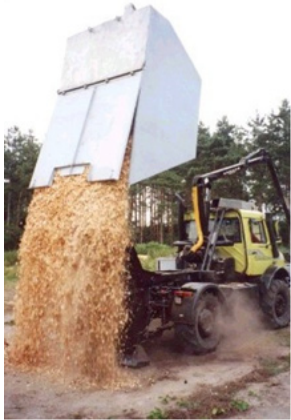
Kuvat 47- 48. Englannissa saksalaisen Unimog'in päälle asennettu ruotsalainen hakkuri, suomalainen kourakuormain ja omatekoinen kontti. Kansainvälinen bioenergiajärjestelmä? (Kuvat:John Alston).
