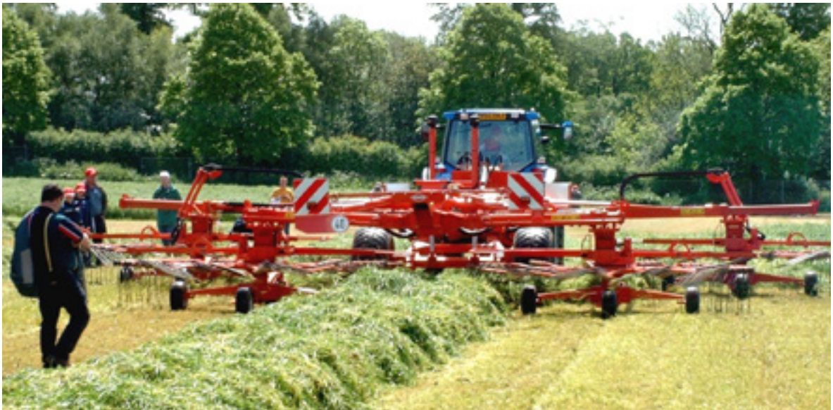
Kuva 40. Kuhn'in säätövyöleveysinen pöyhin, max työleveys 14.5 m. ( Kuva: Kuhn).
