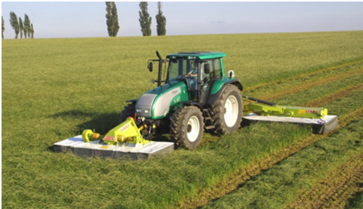
Kuva 39. Samoista niittomurskainmoduuleista voidaan muodostaa erilaisia yhdistelmiä. /5/
