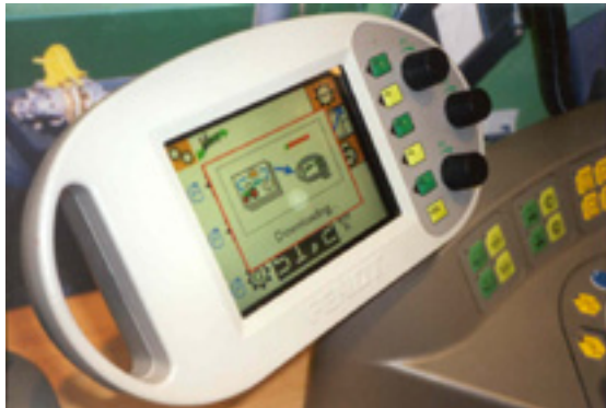
Kuva 50. Variotronic lataa työkonenevälin väylää pitkin työkonenevälin kytkennän jälkeen. /5/
