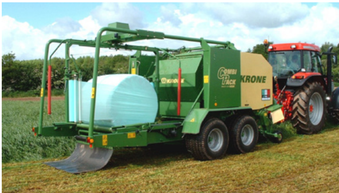
Kuva 42. Krone Combi Pack –yhdistelmä siirtää, käärii ja pudottaa paalin täysautomaattisesti. Kuljettajan tarvitsee vain pysähtyä ja lähteä jälleen liikkeelle merkkiäänän mukaan. (Kuva: Krone).
