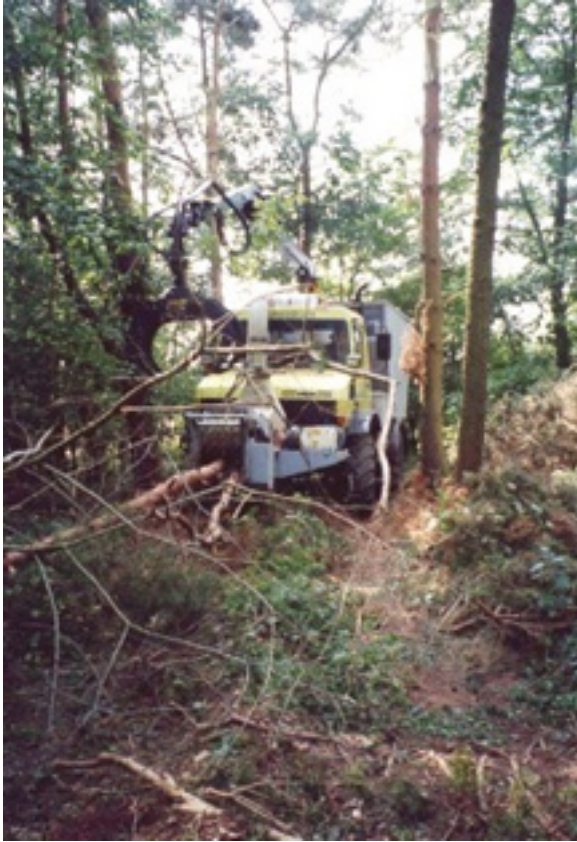
Kuvat 47- 48. Englannissa saksalaisen Unimog'in päälle asennettu ruotsalainen hakkuri, suomalainen kourakuormain ja omatekoinen kontti. Kansainvälinen bioenergiajärjestelmä? (Kuvat:John Alston).
