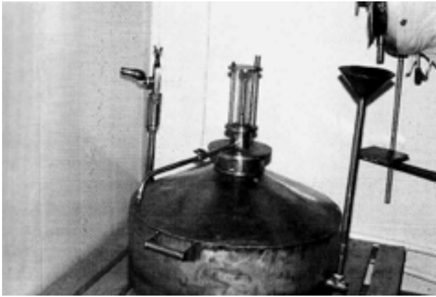
Kuva 11. Pohjois-Pohjanmaan tutkimusasemalla kehitetty ja rakennettu öljynerotin (Kuva: Abbas Aflatuni).
