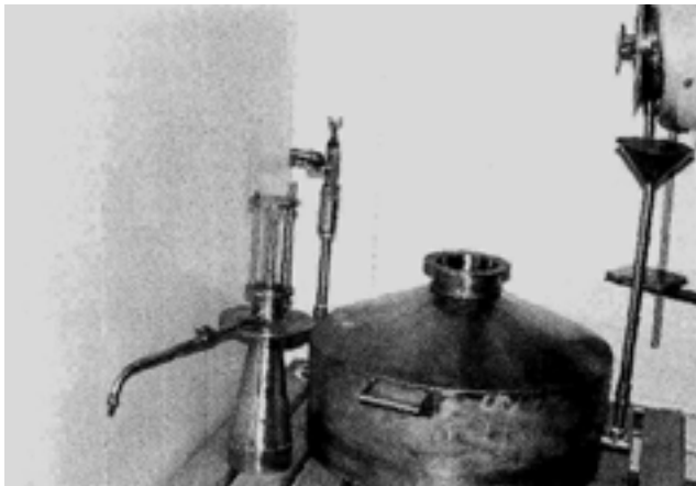
Kuva 12. Pohjois-Pohjanmaan tutkimusasemalla kehitetyn ja rakennetun öljynerotimen sisä- ja runko-osat (Kuva: Abbas Aflatuni).
