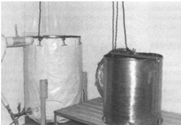
Kuva 4. Kasvimateriaalilla täytetty, reiitetty pohjainen astia nostetaan tislauskattilan sisään (Kuva: Abbas Aflatuni).
