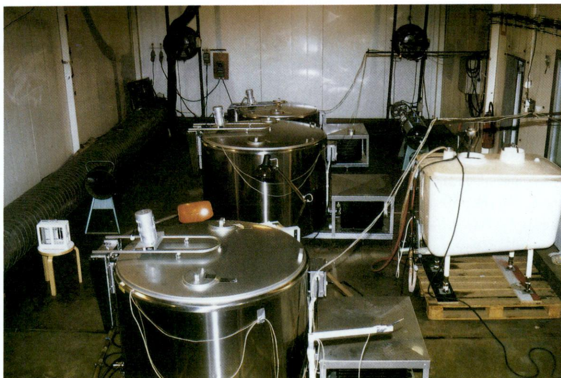
Kuva 5. Tilasäiliöiden jäähdytysominaisuuksien mittausta MTT/VAKOLAssa.
