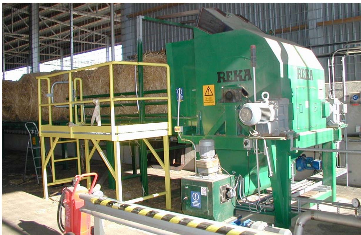
Kuva 8. Ruukohelpipaaleja menossa silppurin kautta polttoon Kokkolan voimalaitoksen automaattisella paalinkäsittelylinjalla. Investoinnit tämän tyyppisiin linjastoihin olisivat välttämättömiä, jotta peltobioenergian käyttö saataisiin kasvuun. (Kuva: Timo Lötjönen, MTT)
