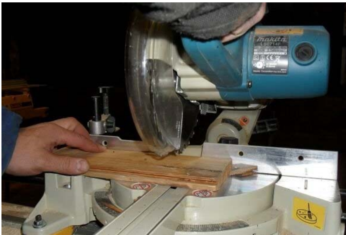
Kuva 5. Onnettomuuksia sattuu usein käsityökoneita käytettäessä. Syynä on monesti koneiden suojainten rikkoontuminen tai niiden irrottaminen, koska niiden koetaan hankaloittavan työtä sekä turha kiire. Kuva: Sarita Ventelä.
