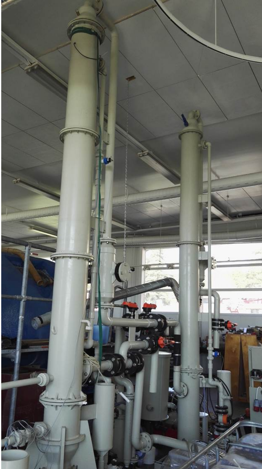
Kuva 2. Pilot-mittakaavan ammoniakkin strippaus- ja talteenottolaitteisto.
