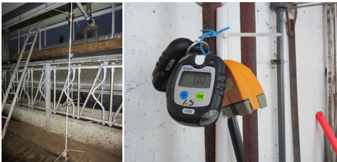
Kuva 14. Mittauspisteissä anturit sijaitsivat kolmella korkeudella, kolmen anturin ryhmissä. Samat anturiyksilöt olivat mittausjaksojen aikana aina samoissa pisteissä.
