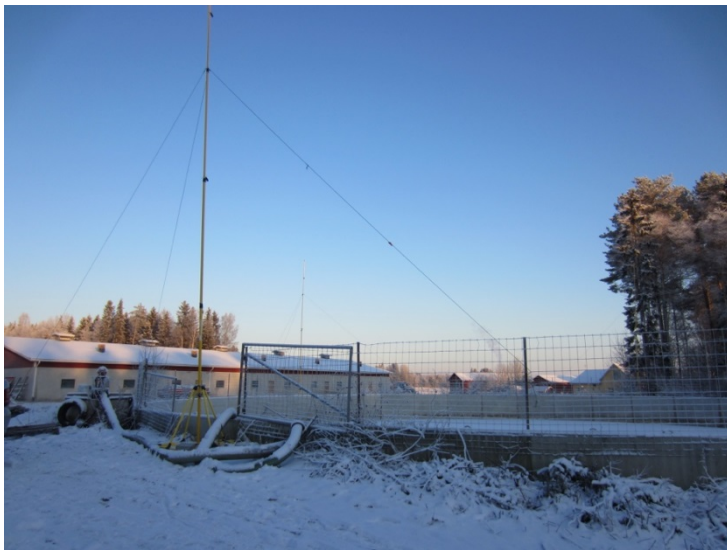
Kuva 20. Mittausmastojen sijoittelu lantavaraston ympärille. 10 metriä korkeita mastoja oli neljä, yksi kussakin pääilman-suunnassa.
