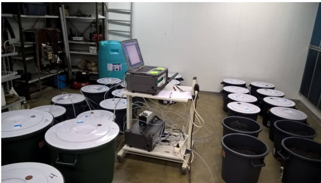
Kuva 5. Kaasumaisten päästöjen (ammoniakki, metaani ja hiilidioksidi) mittaukset laboratoriossa koeastioista. Astiat peitettiin kannella mittauksen ajaksi.
