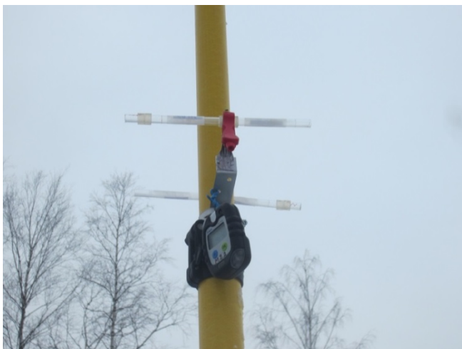
Kuva 21. Mastomittauksen passiiviputket ja PAC 7000 anturi asennettuina samaan mittauspisteeseen mittausmastossa. Passiiviputket ovat lasia ja niissä on toisessa päässä ruostumattomasta teräksestä tehdyt pienireikäiset levyt, jotka hidastavat mitattavan ilman virtausnopeuden sopivaksi. Putkien ulkohalkaisija oli 10 mm (sisähalkaisija 7mm) ja pituus 210 mm.
