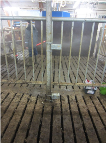
Kuva 15. Lehmien kulkualueille sijoitetut anturit suojattiin metallikotelolla.
