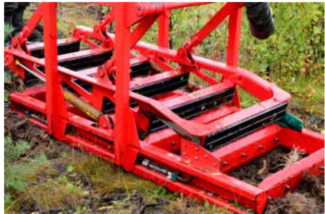
Kuva 1. Alkuperäinen kapea kitkentälaitte P25. (valokuva Ville Kankaanhuhta)
