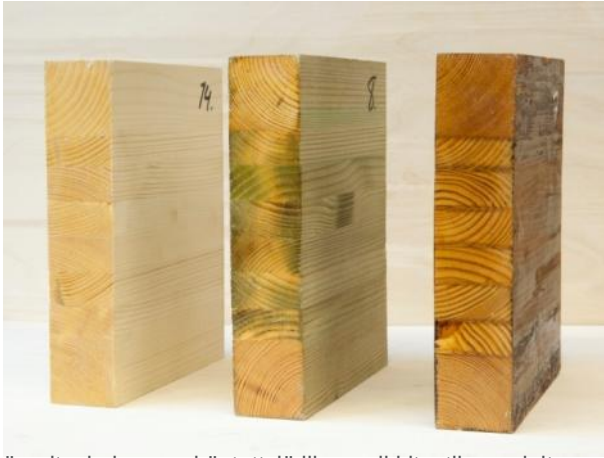
Vesiupotus-/säätuskokeessa käytettyjä liimapalkkitekstikappaleita (vasemmalta: käsittelemätön, CC-kyllästetty, mäntyöljykyllästetty)
