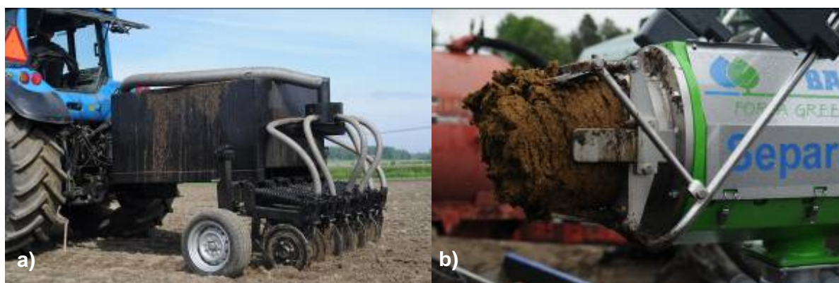
Kuva 1. a) Raakalannan ja käsittelyjäännöksen levitykseen käytetty sijoittava konttilevitin. b) Kuivajakeen separointia. Kuvat: Perttu Virkajärvi.
