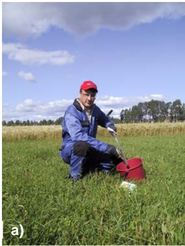
Kuva 3. a) Maanäytteiden ottoa käsin kairaamalla. Kuva: Luke Maaningan arkisto. b) Maanäytteiden ottoa traktorikairalla. Kuva: Mari Rätty. Kuvat eivät ole tämän tutkimuksen kokeilta.
