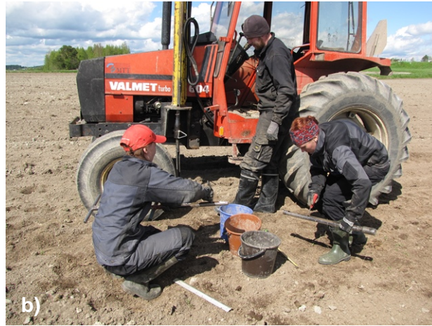
Kuva 3. a) Maanäytteiden ottoa käsin kairaamalla. Kuva: Luke Maaningan arkisto. b) Maanäytteiden ottoa traktorikairalla. Kuva: Mari Rätty. Kuvat eivät ole tämän tutkimuksen kokeilta.
