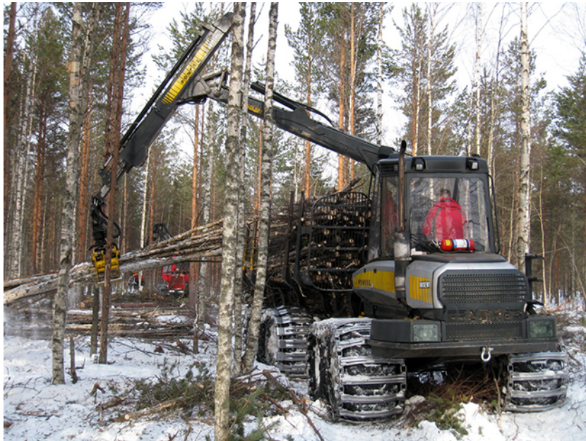
Kuva 8. Puutavaran kuormainvaakamittauksen ensimmäinen vaihe palstalla kuormauksen yhteydessä (J. Laitila/Metla).
