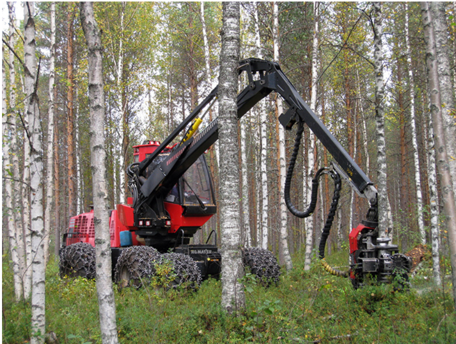
Kuva 1. Komatsu 901.4 hakkuukone ja 350.1 hakkuulaite (J. Laitila/Metla).
