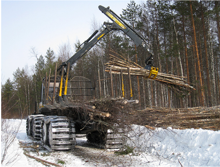
Kuva 9. Puutavaran kuormainvaakamittauksen toinen vaihe tienvarsivarastolla purkamisen yhteydessä (J. Laitila/Metla).
