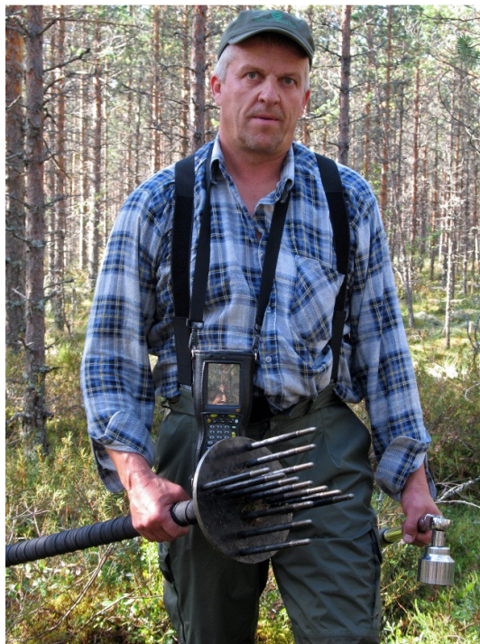
Kuva 10. Leikkausmodulin mittauksessa käytetty piikkisiipikaira. Kuva: Metla/Hannu Latvajärvi.
