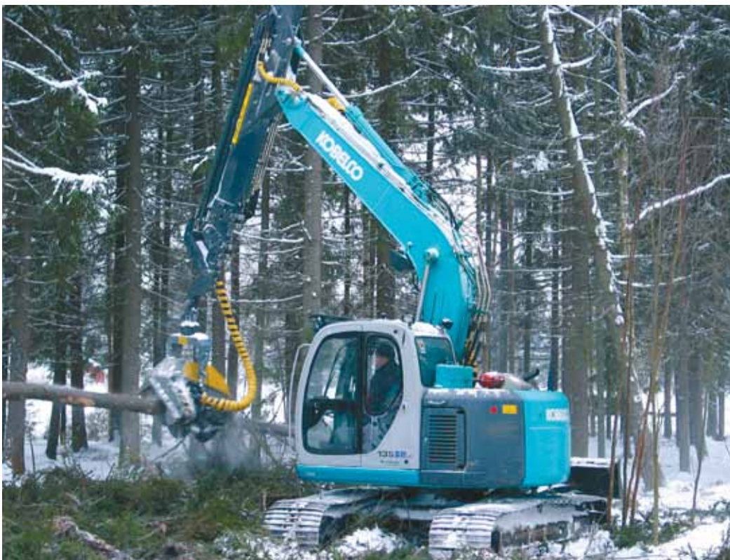
Kuva 19. Kaivukonealustainen hakkuukone (Kari Väätäinen/Metla).
