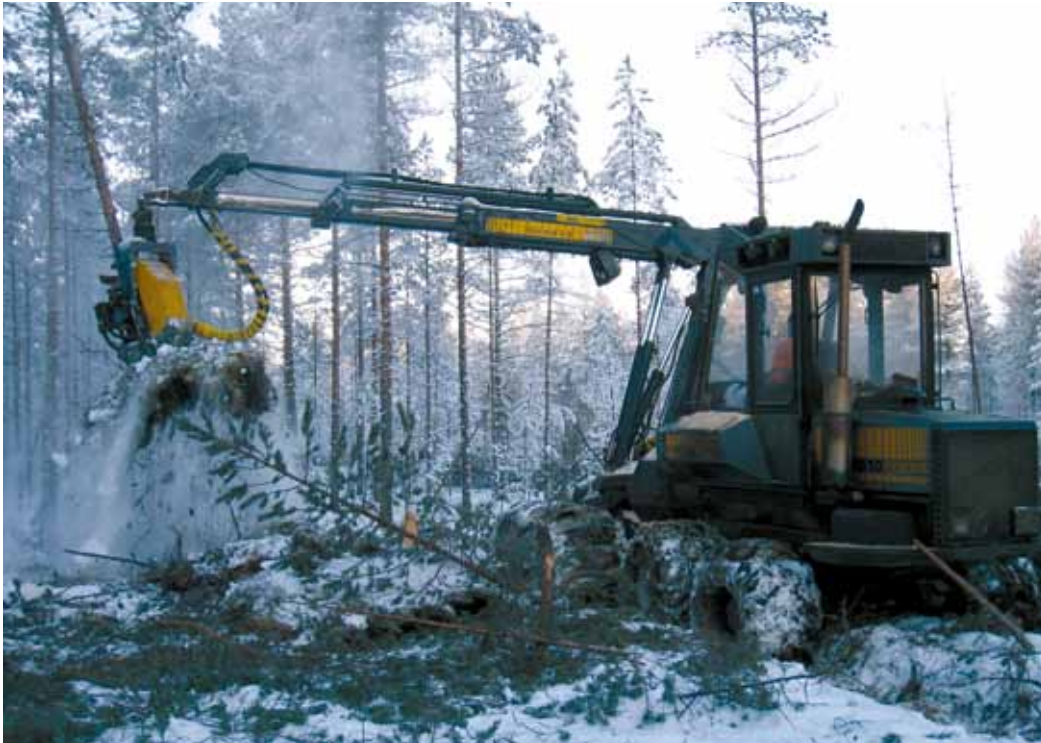
Kuva 18. Kanto- ja juuripuun korjuuta hakkuutyön yhteydessä (Juha Laitila/Metla).
