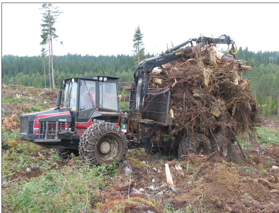
Kuva 3. Kantojen metsäkuljetusta Valmet 860 metsätraktorilla (kuva J. Laitila/Metla).
