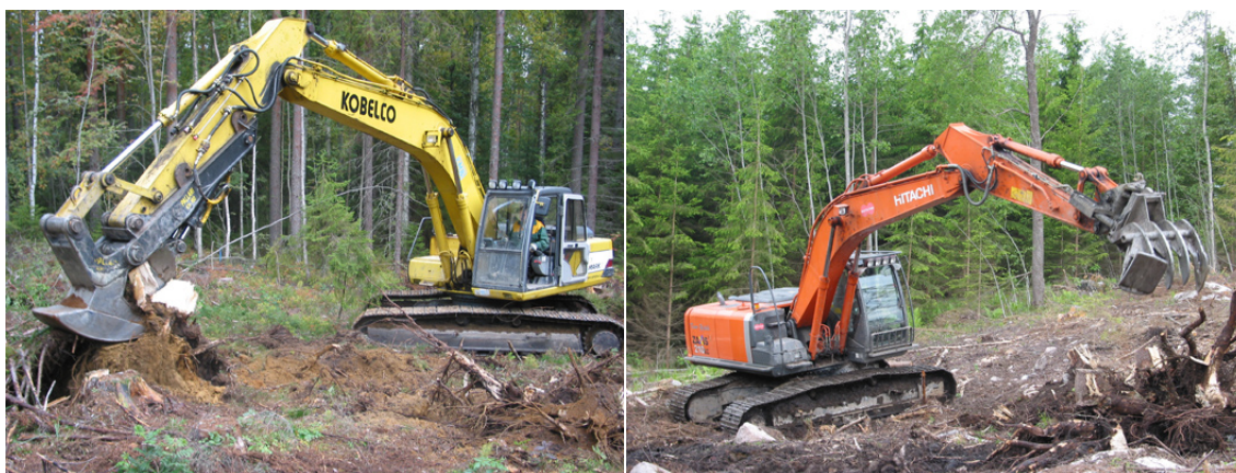
Kuva 1. Kantoharvesteri (Pallari KH160, valmistaja Tervolan Konepaja Oy) ja kantohara (valmistaja A.Hirvonen Oy) kantojen nostotyössä (kuvat J. Laitila/Metla).
