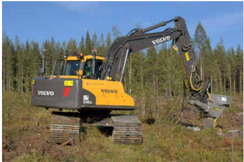
Kuva 3. Taimet istutettiin Bracke P11.a istutuskoneella ja paikkatieto kerättiin Scanlaserin 3D-koneohjausjärjestelmän avulla. (valokuva Miia Parviainen)
