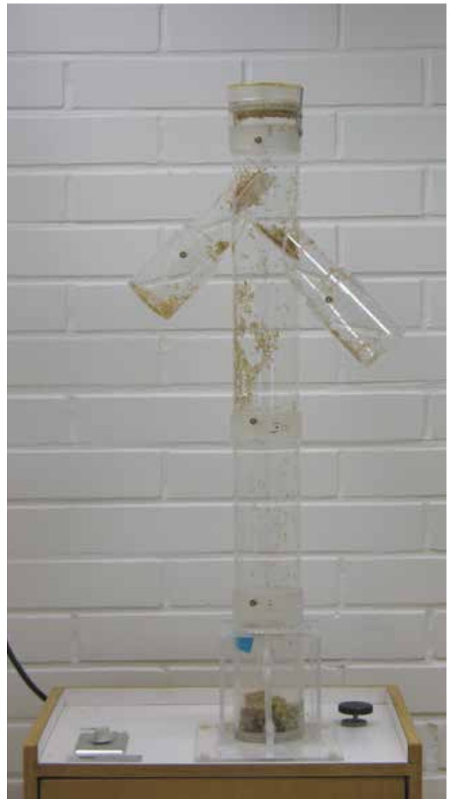
Kuva 1. Puhallusilmalajittelija puhdistamassa koivun siemeniä. Puhdistamaton siemen laitetaan putken alapäässä olevaan astiaan, jonka yläosa on avoin ja pohja tiheää mesinkiverkkoa. Kaapin sisällä oleva sähkömoottorin pyörittämä keskipakopuhallin puhalttaa ilmaa verkon ja sen päällä olevan siemen- ja eminorkkomassan läpi. Eminorkkoja kevyemmät siemenet leijailevat putkessa korkeammalle ja putoavat lopulta putken molemmilla sivuilla oleviin keräimiin. Puhalluksen voimakkuutta säädetään putken yläpäässä olevan poistoilma-aukon kokoa muuttamalla (valokuva Pekka Helenius)
