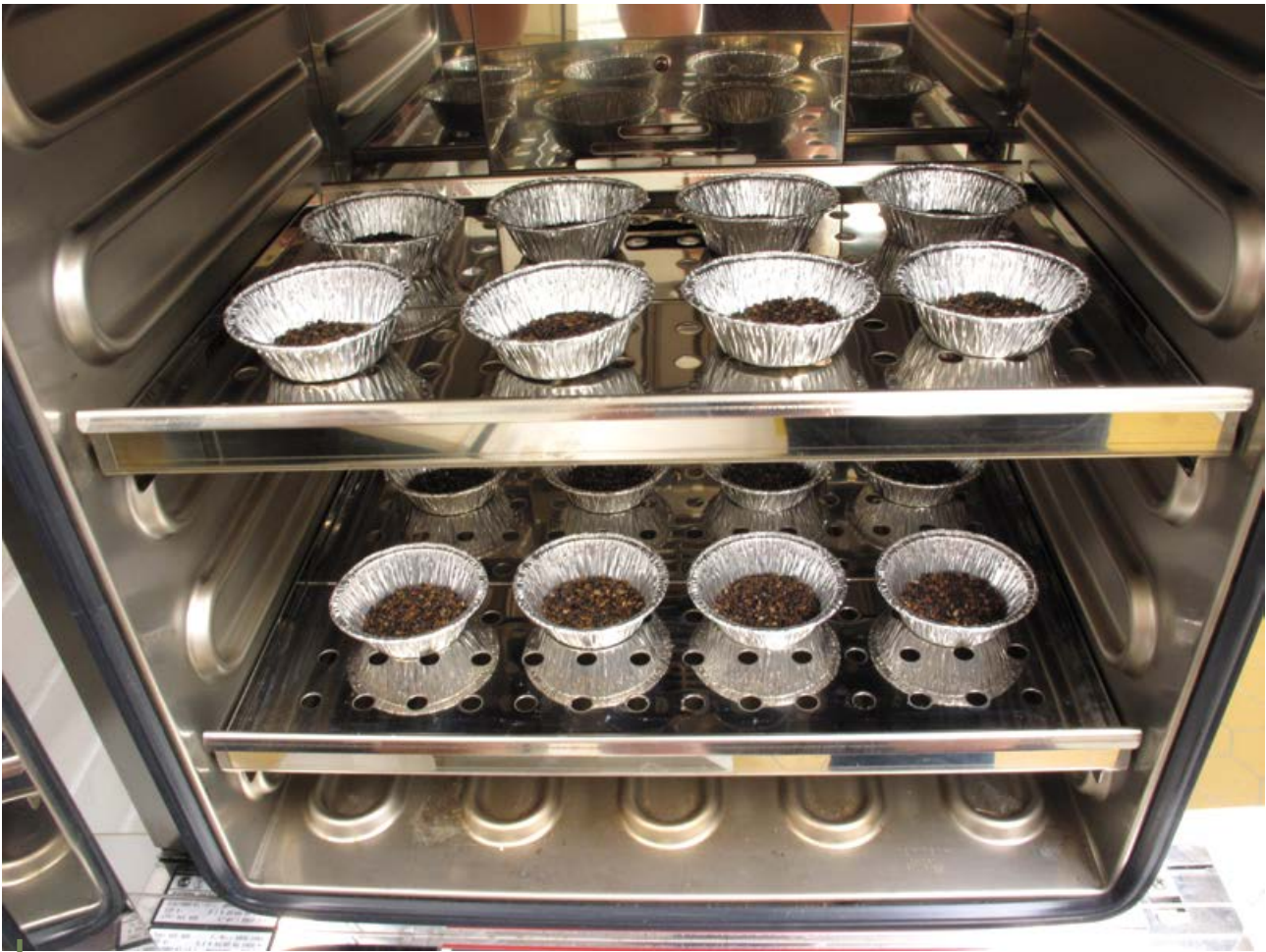
Kuva 4. Uunikuivauksessa näytteet kuivataan folioastioissa 103 °C tai 130 °C lämpötilassa. Kerralla saadaan mitattua helposti tusinan verran näytteitä. (valokuva Katri Himanen)
