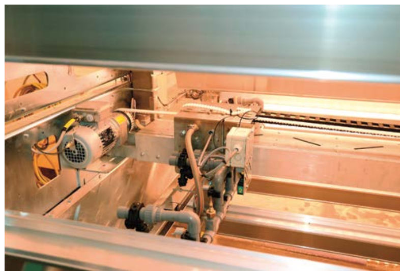
Kuva 3. Taimikennostot kastellaan automaattisesti kasvatuskammion alaosassa oheisella laitteistolla. (valokuva Ville Kankaanhuhta)
