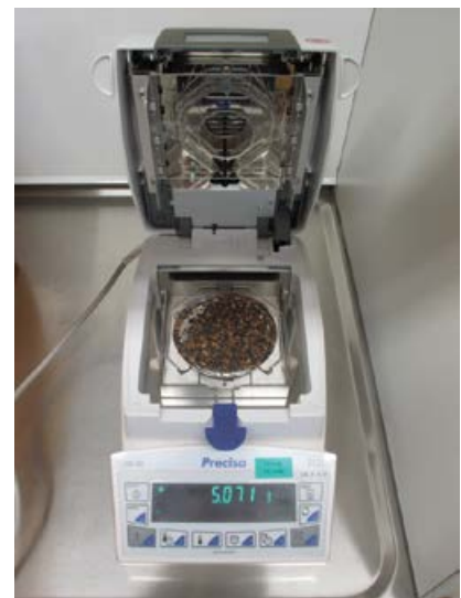
Kuva 2. Infrapunamittari. Halogeenilampun emittoima infrapunasäteily kuivaa siemenet ja laitteen vaaka punnitsee näytteen painoa samalla. (valokuva Katri Himanen)
