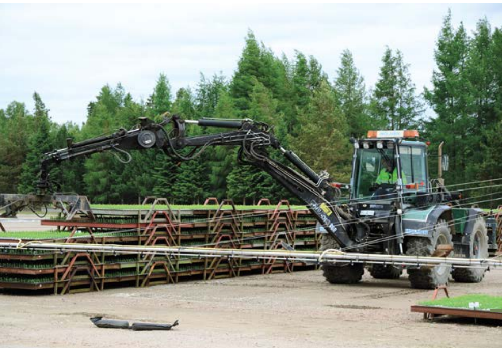
Kuva 4. Taimikennostoja siirrellään Friggesundissa päällekkäin pinottavilla kasvatustasoilla. (valokuva Ville Kankaanhuhta)
