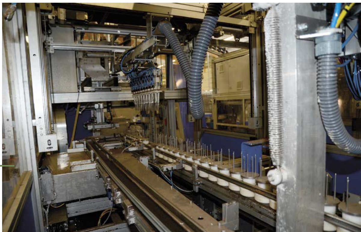
Kuva 5. Taimet käsitellään koneellisesti vahalla tukkimiehentäin syönnin ehkäisemiseksi oheisen laitteiston avulla. (valokuva Ville Kankaanhuhta)
