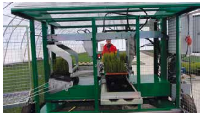
Kuva 2. Valmiiksi pakattu ritilälaatikko on vasemmalla olevalla vastaanottopöydällä. Samanaikaisesti irrotuspöydän kohdalla tarttujassa olevat irrotetut taimet odottavat siirtopöydälle laskemista. (valokuva Marja Poteri)
