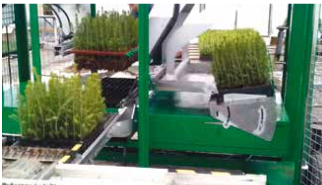
Kuva 1. OSMA-laite taimikennostojen syöttöpäästä katsotuna. Oikealla valmiiksi pakattu ritiläkennosto. Vasemmalla näkyy punaisten lamellien varassa kahdesta kennostosta nostetut taimet, jotka lasketaan kuvan keskellä liikkeessä olevalle siirtopöydälle. Syöttöpöydällä uudet kennostot valmiina siirtymään irrotuspöydälle. (valokuva Timo Korhonen)
