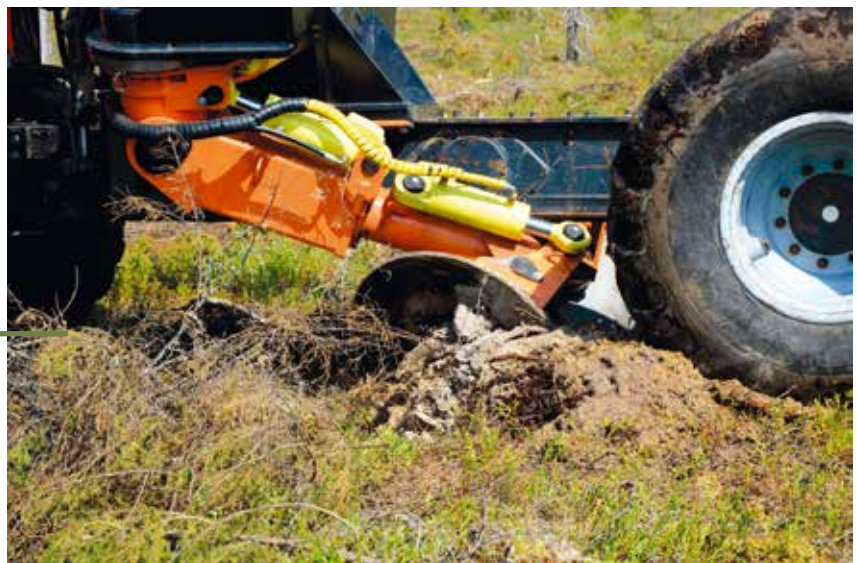
Kuva 2. Metsäkoneen takapyörät tiivistävät muokkauslaitteen tekemän jäljen. (valokuva Ville Kankaanhuhta)
