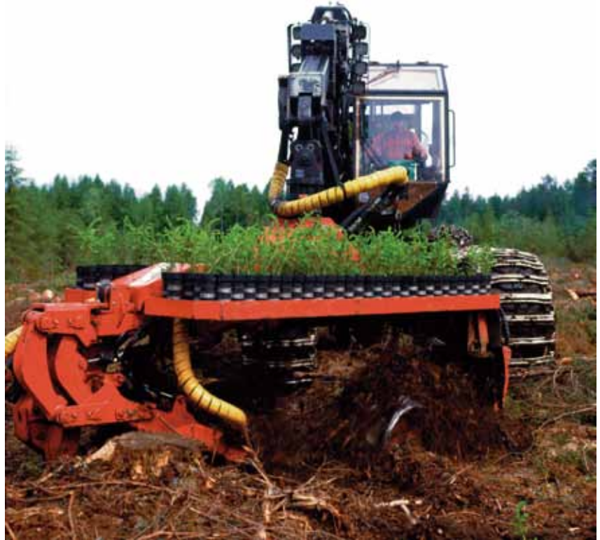
Kuva 2. Nykyisin jo käytöstä poistunut kaksipäinen Ecoplanter-istutuskone. (valokuva Leo Tervo)
