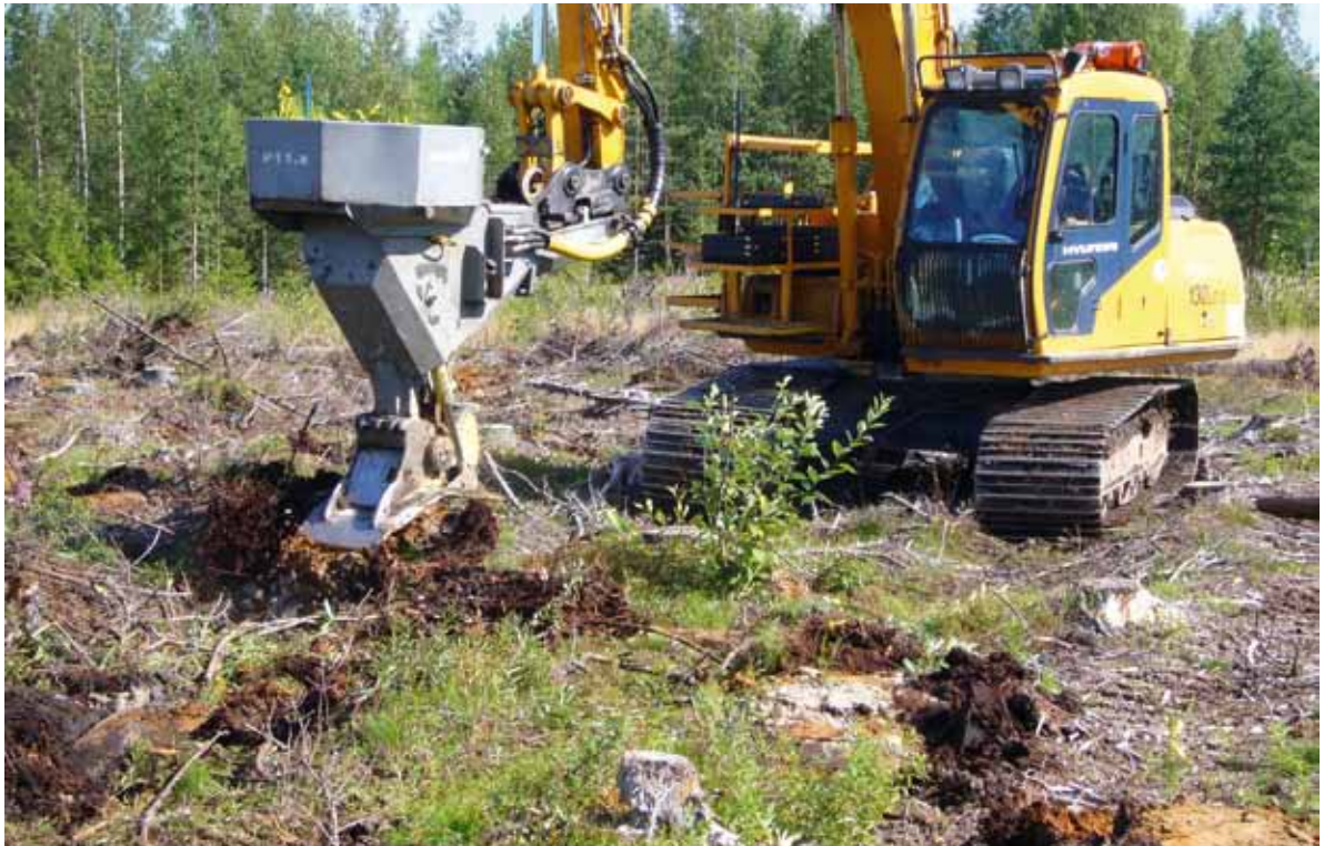
Kuva 1. Brake-istutuskone kuusen paakkutaimia istuttamassa Suonenjoella. (valokuva Jaana Luoranen)
